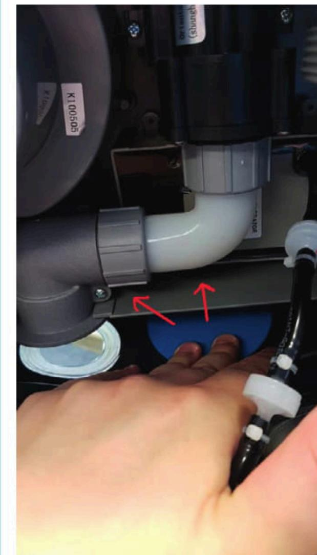
Blir det för trångt att få in handen, kan du lossa luftröret.
